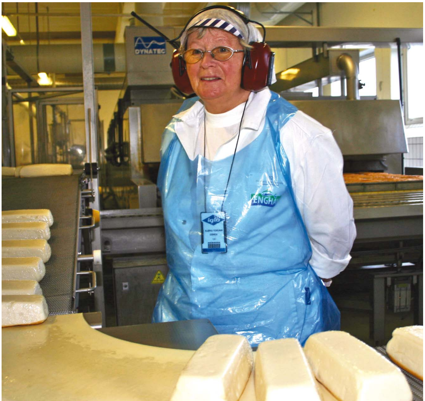
TUNNELOVN: Bjørg Osnes konstaterer at den nye tunnelovnen er helautomatisert og ”spyr ut” ferdigsteckt fiskepudding.
